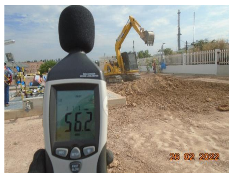
ภาพที่ 2-10 การตรวจวัดเสียงและการควบคุมเสียงจากแหล่งกำเนิดขณะที่มีกิจกรรมก่อสร้าง
